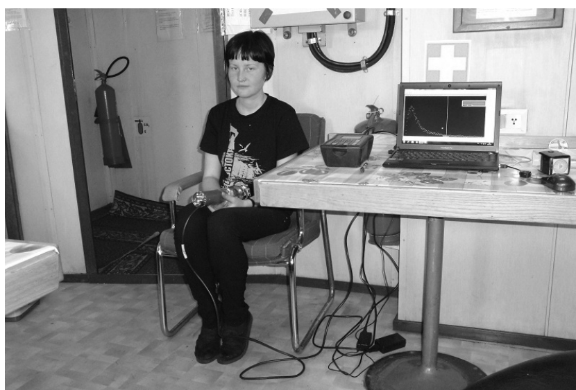
Рис. 6. Проведение СИЧ-измерений на борту судна с использованием сцинтилляционного гамма-спектрометра «DigiDART»
