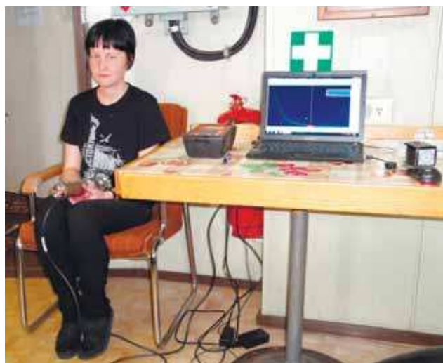
Рис. 26. Проведение СИЧ-измерений на борту судна с использованием сцинтилляционного детектора и гамма-анализатора «DigiDART» (детектор удерживается в руках, при этом кристалл детектора обращен к животу обследуемого человека)
