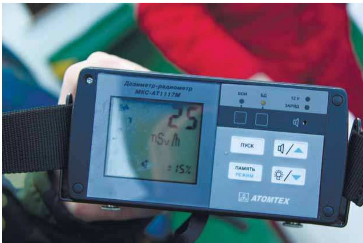
Рис. 17. Показания дозиметра-радиометра MKS-AT1117M, зарегистрированные в момент отбора пробы воды в Тихом океане на станции РГО-3 28 апреля 2011 г. Мощность дозы равна 25 нЗв/час при статистической ошибке 15%. Фото И. Ермаченкова
