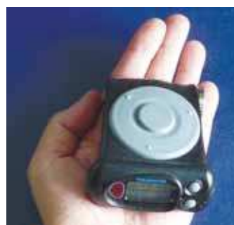
Рис. 9. Индивидуальный дозиметр гамма-излучения ДКГ-РМ1621. Видны органы управления (две серые кнопки справа), инфракрасный порт передачи информации (слева) и дисплей (в середине) на лицевой панели. Большой серый круг (детектор) размещен на стороне, обращенной во внешнее пространство при ношении дозиметра испытуемым субъектом
