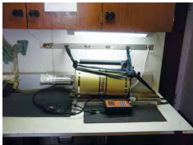
Рис. 14. Определение спектрального состава фона гамма-излучения в помещении № 223 НИС «Павел Гордиенко» с помощью полупроводникового гамма-спектрометра фирмы ORTEC. Спектрометр закреплен на лабораторном столе во избежание повреждений во время шторма и резких маневров судна
