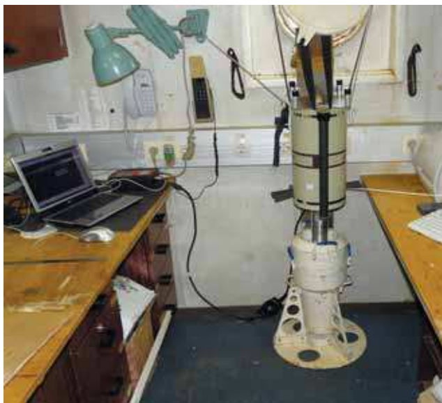
Рис. 16. Полупроводниковый гамма-спектрометр в рабочем положении во время измерения одной из проб сорбента. Проба помещена в металлический контейнер, который вместе с торцевой частью детектора находится внутри свинцовой защиты и на фотографии не виден
