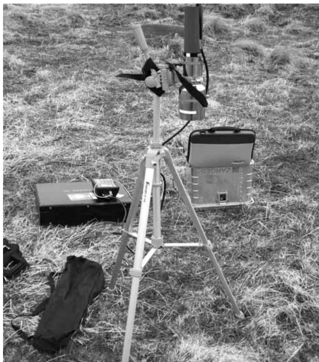
Рис. 1. Определение энергетического спектра гамма-фона с помощью полевого сцинтилляционного гамма-спектрометра «DigIDART»
