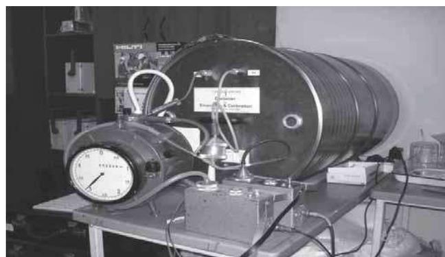
Рис. 1. Установка для определения плотности потока радона с поверхности облицовочных изделий в лабораторных условиях
