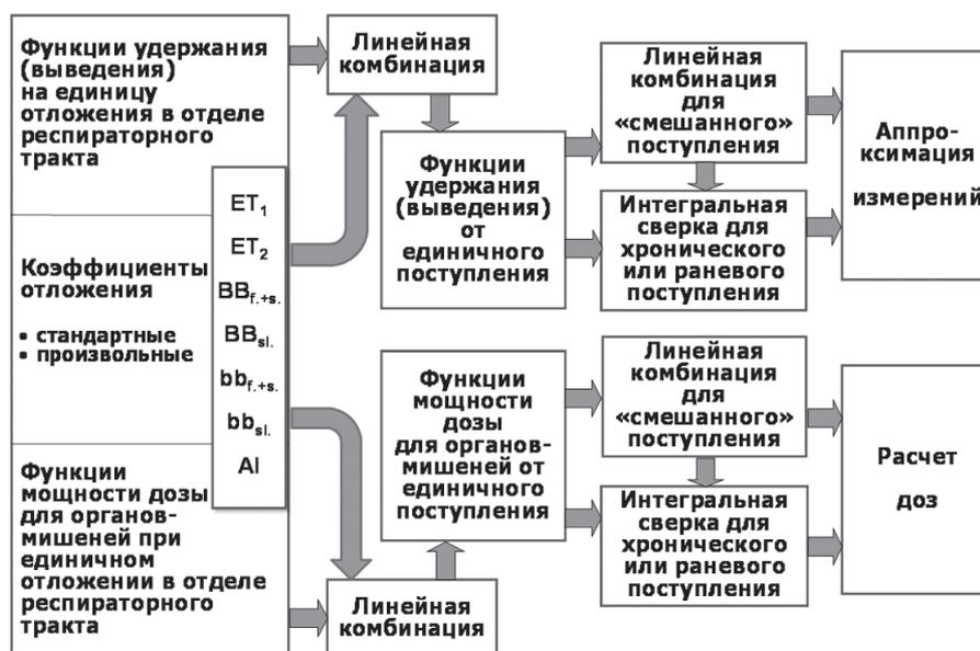
Рис. 1. Структура библиотеки функций отклика на единичное воздействие, используемой в компьютерной системе поддержки дозиметрической интерпретации внутреннего облучения
