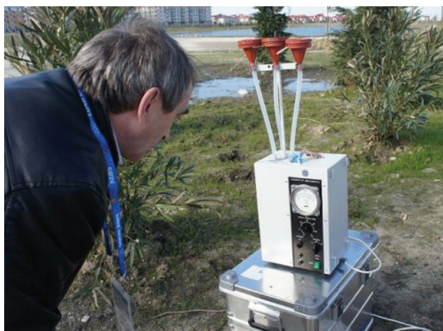
Рис. 2. Мобильная установка для прокачки проб атмосферного воздуха через аэрозольные фильтры
