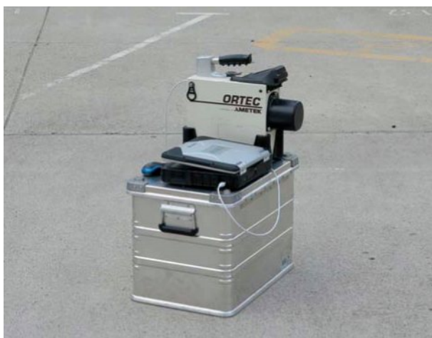
Рис. 1. Полевой полупроводниковый гамма-спектрометр с электроохлаждением
