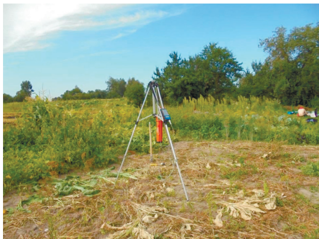
Рис. 1. Гамма-спектрометрические измерения in situ на огородном участке Per-9 в НП Денисовичи. Прибор МКС АТ6101Д размещен на треножке. Август 2020 г.
