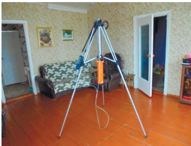
Рис. 3. Размещение спектрометра-дозиметра AT6101D при проведении гамма-спектрометрических измерений внутри жилого дома; НП Малая Топаль, август 2020 г.
