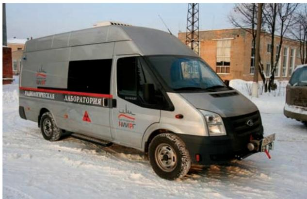
Рис. 1. Передвижная радиологическая лаборатория ФБУН НИИРГ на базе Ford Transit VAN
