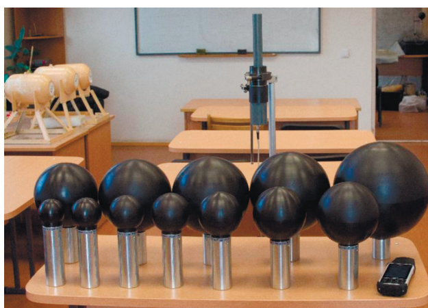
Рис. 2. Внешний вид дозиметра-радиометра МКС-АТ1117М с блоком детектирования БДКН-06 и набором сфер-замедлителей [Fig. 2. Appearance of the dosimeter-radiometer AT1117M with the detection unit BDKH-06 and a set of moderator spheres]
