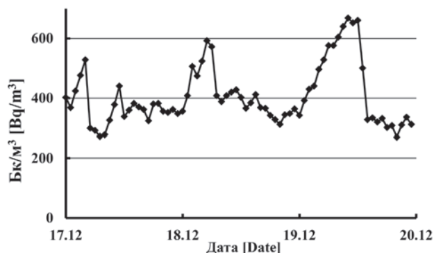
Рис. 7. Временная серия ОА радона, измеренной с помощью радон-монитора с интервалом в 1 ч, в квартире с максимальной измеренной ОА радона
