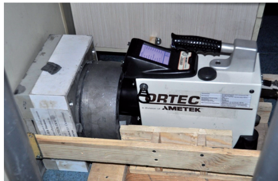
Рис. 2. Полевой электроохлаждаемый полупроводниковый гамма-спектрометр с детектором из особо чистого германия TSP-DX-100T-PAC-PKG-1 со свинцовой защитой во время проведения измерений
