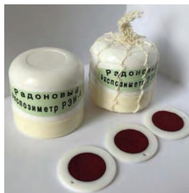
Рис. 2. Пробоотборная камера РЭИ-4
