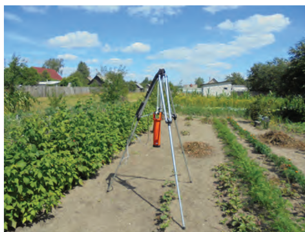
Рис. 1. Расположение спектрометра-дозиметра МКС АТ6101Д на треноге во время проведения полевых измерений на огородных участках; населенный пункт Злынка, 3 августа 2020 г. [Fig. 1. Placement of the MKS AT6101D spectrometer-dosimeter on a tripod during field measurements in kitchen gardens; the settlement Zlynka, 3 August 2020]
