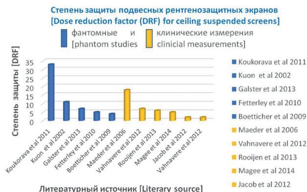
**Рис. 5.** Степень защиты подвесных рентгенозащитных экранов. Литературные данные по фантомным [19–23] и клиническим измерениям [16, 24–27]
