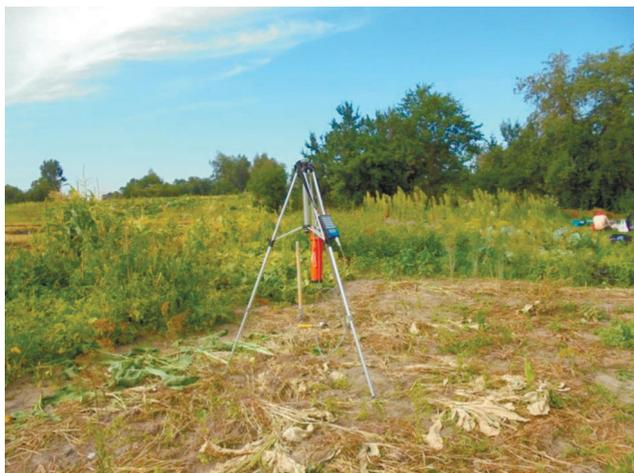
**Рис. 1.** Гамма-спектрометрические измерения *in situ* на огородном участке Per-9 в НП Денисовичи. Прибор МКС АТ6101Д размещен на треножнике. Август 2020 г.
