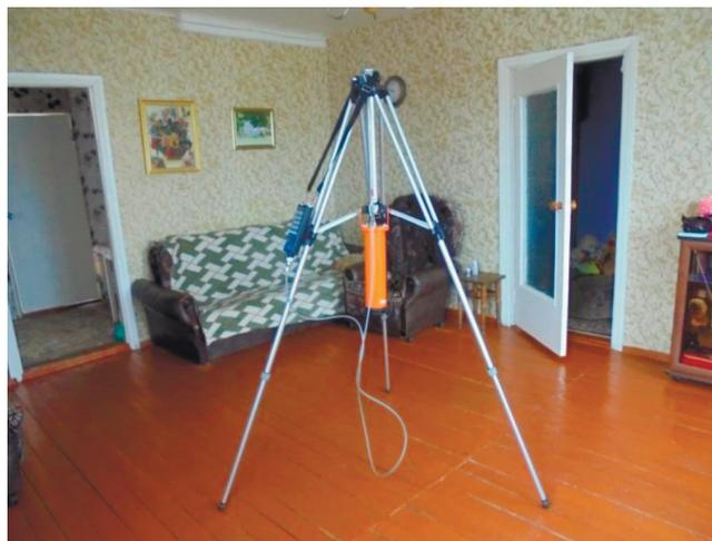
**Рис. 3.** Размещение спектрометра-дозиметра АТ6101Д при проведении гамма-спектрометрических измерений внутри жилого дома; НП Малая Топаль, август 2020 г.
