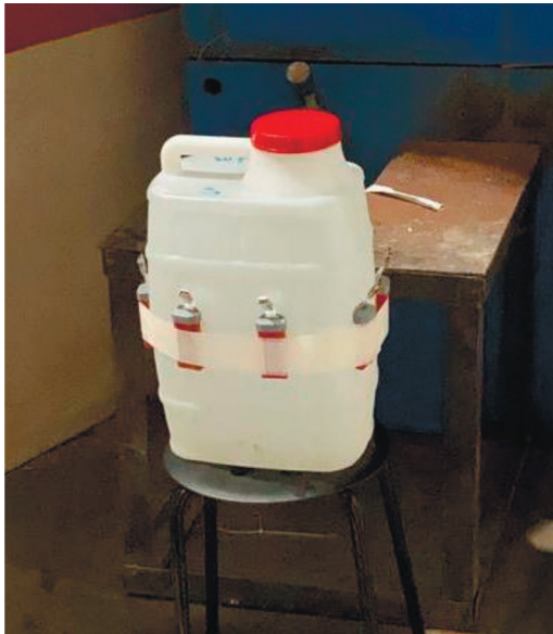
Рис. 3. Пример размещения индивидуальных дозиметров на фантоме [Fig. 3. The example of personal dosimeters placement on phantom]
