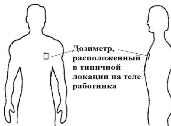
Рис. 1. Типичное расположение индивидуального дозиметра на поверхности тела работника [Fig. 1. A typical location of an individual dosimeter on the surface of the employee's body]
