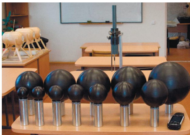
Рис. 2. Внешний вид дозиметра-радиометра МКС-АТ1117М с блоком детектирования БДКН-06 и набором сфер-замедлителей [Fig. 2. Appearance of the dosimeter-radiometer AT1117M with the detection unit BDKN-06 and a set of moderator spheres]
