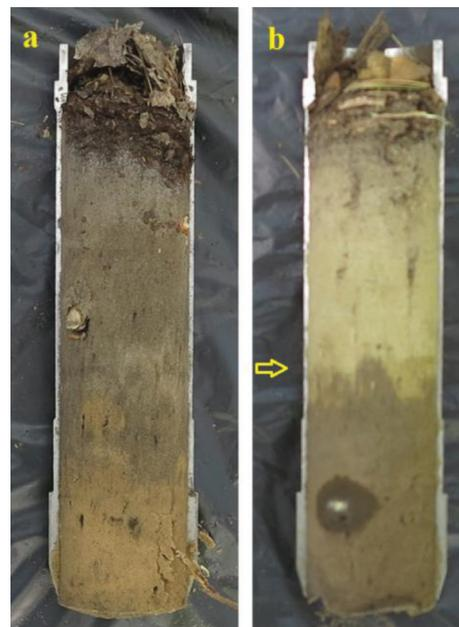
**Рис. 3.** Керны почвы, отобранные в 2015 г. на базе «Муравинка» на недезактивированной территории (а) и дезактивированной площадке (б). Длина кернов равна примерно 20 см. Стрелкой показана граница между слоем насыпанного песка и материнской почвой
