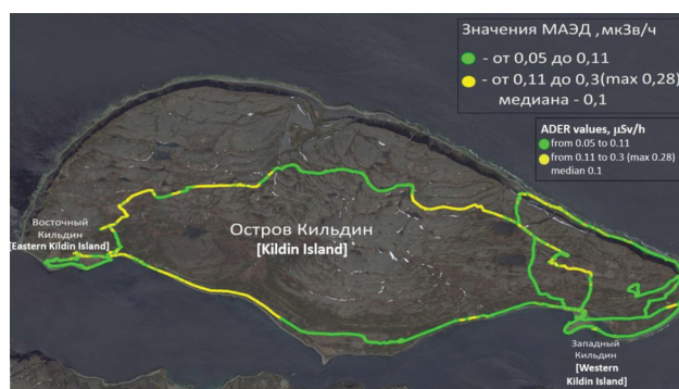
Рис. 3. Картограмма значений МАЭД по результатам пешеходной гамма-съемки на территории острова Кильдин [Fig. 3. Cartogram of ADER values based on the results of pedestrian gamma survey in the territory of Kildin Island]
