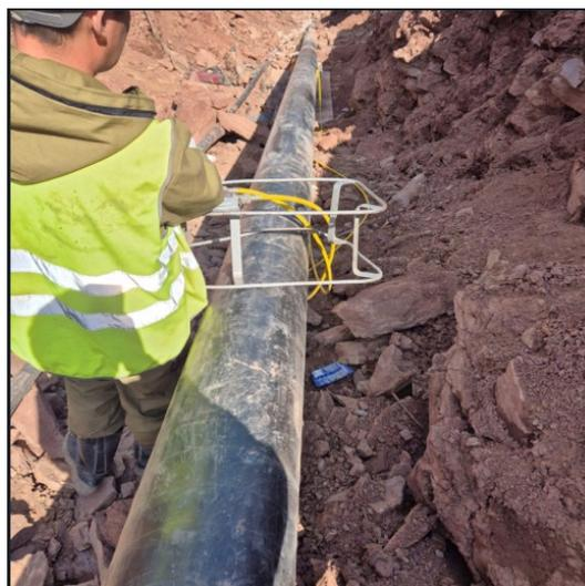
**Рис. 3.** Просвечивание изделия
